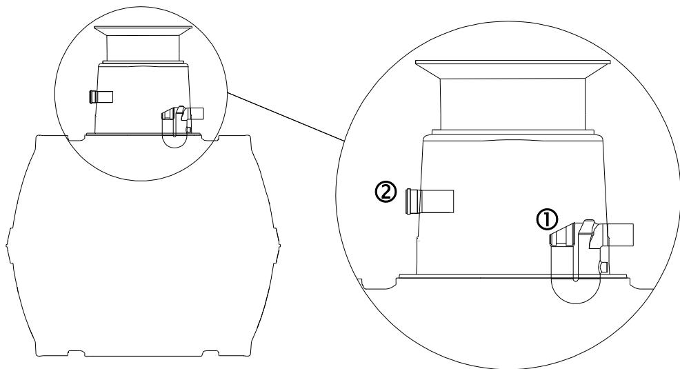
① Insérez le siphon dans le joint inférieur jusqu' à la butée.
