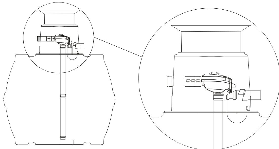
Placez le filtre avec le sabot et tuyau anti-remous dans la cuve. Posez le trop-plein du filtre sur le siphon et branchez l'arrivée d'eau de pluie au filtre à l'aide de la manchette de fixation (contenue dans le pack accessoires n° 3).
