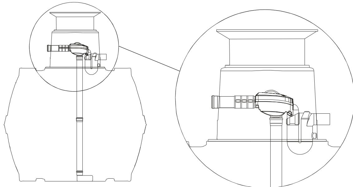
Den mit dem beruhigten Zulauf und Zulauftopf vorbereiteten Filter in den Tank einsetzen. Dabei den Überlauf des Filters von oben in den Siphon schieben und das Zulaufrohr mit dem Filterzulauf mittels Spannfixmanschette (im Ausbaupaket 3 enthalten) verbinden.
