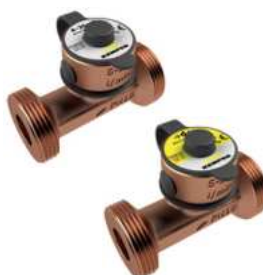
CONTROL-PLUS Durchfluss- und Temperatur- messarmatur, Figur 138 4G/GLT-Version Figur 138 6G Zur exakten Ermittlung und Einregulierung von Volumenströmen in Trinkwassersystemen. Druck- verlustarmes Sensorgehäuse; min. Fließgeschwin- digkeit 0,2 m/s; max. Fließgeschwindigkeit 2,5 m/s; Temperaturmessbereich 0 - 100 °C.
